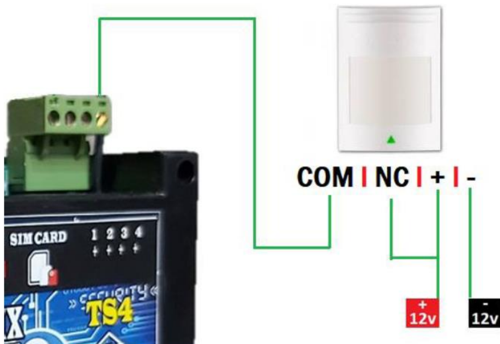
نحوه اتصال چشمی به ورودی 4 دستگاه چهار کانال
