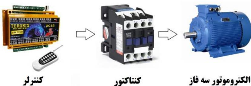
مطابق تصویر زیر ، فاز پس از ورود به COM1 و خروج از NO1 وارد ترمینال A1 کنتاکتور شده و ترمینال A2 کنتاکتور به نول وصل شده است. ( اتصال رله دستگاه به بوبین کنتاکتور )
