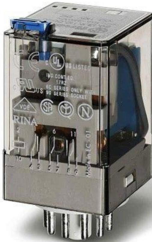
مطابق راهنمای مندرج روی رله شیشه ای فوق پایه های 2 و 10 کویل یا بوبین رله هستند. اگر رله شیشه ای ما 220 ولت باشد کافی است پایه 2 مستقیماً به نول و پایه 10 به ترمینال NO در دستگاه رسیور متصل شود. ترمینال COM در دستگاه رسیور نیز به فاز شبکه برق وصل شود که برای بوبین رله جریان برق را فراهم کنند.
