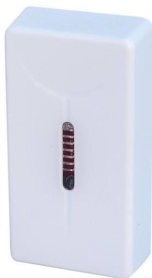
تصویر یک سنسور لرزشی بی سیم جهت محافظت از شکستن شیشه و خراب کردن دیوارها
