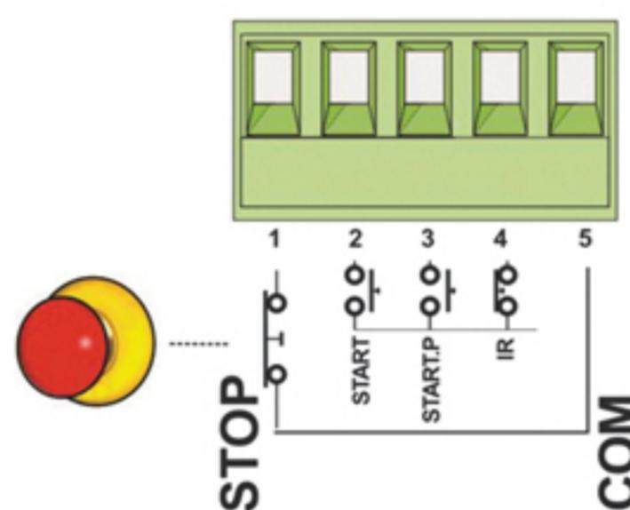
اگر در مدت زمان شمارش معکوس بسته شدن درب این شستی فشرده شود، بسته شدن اتوماتیک درب غیرفعال شده و درب در حالت توقف قرار می‌گیرد. برای بسته شدن درب با ریموت به سیستم، فرمان بسته شدن اعمال شود.
