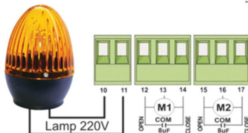
در صورتی که bLin no باشد خروجی فلاشر ولتاژ 220 ولت ثابت خواهد شد.
