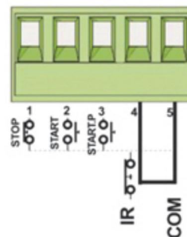
چشمی را با توجه به مطالب زیر می‌توان به مرکز کنترل متصل نمود: چشمی می‌بایست در قسمت بیرونی درب نصب شود و فقط در هنگام بسته شدن درب فعال است. اگر مانع مانند اتومبیل ارتباط چشمی‌ها را در هنگام بسته شدن درب قطع کند، برد کنترل حرکت درب را بدون وقفه معکوس کرده و درب باز می‌شود. در این حالت از ترمینال IR(4) برای نصب چشمی استفاده می‌شود.
