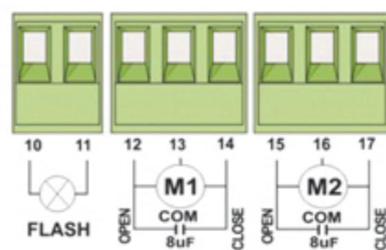
ترمینال 10 و 11 برای نصب فلاشر در نظر گرفته شده است. این فلاشر جهت ایمنی بیشتر و اعلام هشدار، در هنگام باز و بسته شدن درب عمل خواهد کرد. با توجه به منوی bLin می‌توان خروجی این ترمینال را تنظیم کرد. در صورتی که bLin YES باشد مدار فلاشر روی برد فعال شده و کافی است به خروجی ترمینال یک لامپ 220 ولت متصل نمایید.
