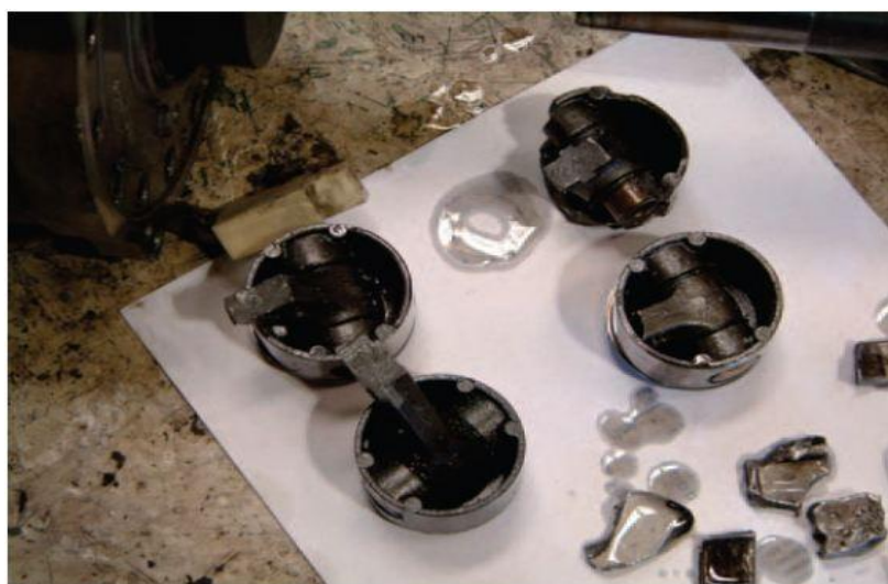
شکسته شدن قطعات کمپرسور
