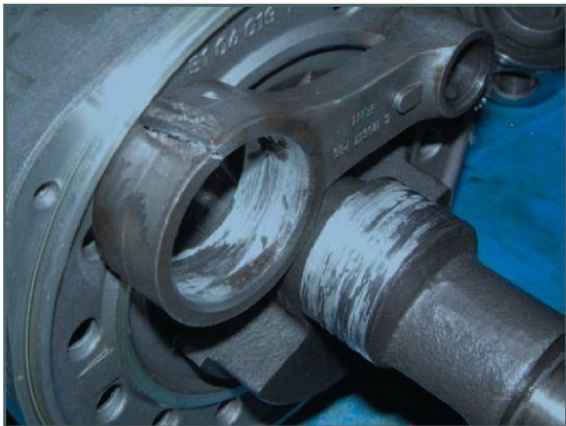
در این تصویر شما شاهد جوش خوردن ذرات جدا شده از دسته پیستون به میل لنگ به علت شسته شدن روغن از روی سطح این قطعات توسط مایع مبرد هستید
