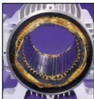
۱۲- سوختگی در یک فاز در اتصال مثلث
