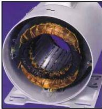
14- سوختن سیم پیچ کمکی
