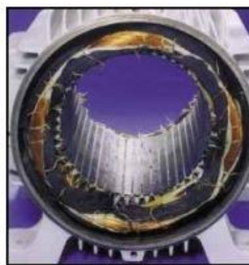
۹- سوختگی یک فاز در اتصال Y
