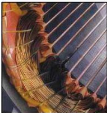
4- سوختگی سیم پیچ در نوک شیار
