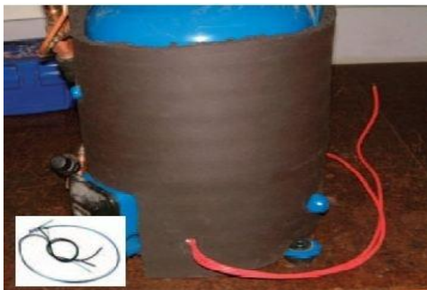
این کمپرسور جهت جلوگیری از کوچ گاز میرد به روغن داخل کمپرسور به گرمکن کمربندی و عایق در سطح بدنه مجهز شده است
