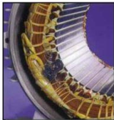
7- تخریب سیم پیچ بعلت افزایش ولتاژ
