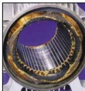
۱۱- سوختگی سیم پیچ بعلت ولتاژ غیر عادی
