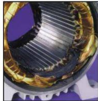
1- سوختگی در یک کلاف
