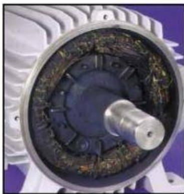
8- سوختگی کامل سیم پیچ بعلت گیرپاژ روتور
