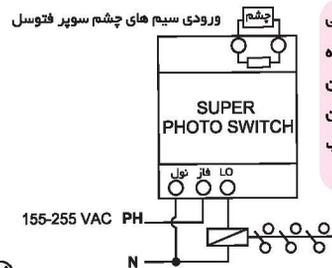
**توجه:** از وصل کردن مستقیم بارهای خازنی یا سونیچینگ یا درایورهای LED به دستگاه به دلیل جریان بیش از حد راه اندازی در این نوع مصرف‌کننده‌ها، خودداری گردد. در این موارد الزاماً از رله خارجی یا کنتاکتور مناسب استفاده گردد.
