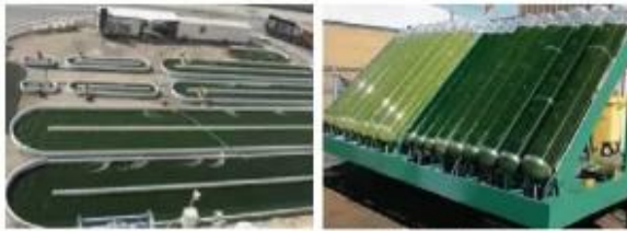
شکل ۱۷. دو نوع فتوسینورکتور که در آن جلبک تک‌یاخته‌ای کشت شده است.
