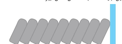
پس وجود سلسله‌ای از آجرهای تکیه‌داده به هم و ایستاده تنها با وجود تکیه‌گاه عمود ممکن است؛ و گرنه کل آجرها روی زمین خواهند افتاد.
