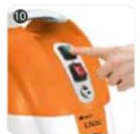
دکمه سبز را فشار دهید اگر دستگاه روشن باشد چراغ LED روشن میشود
